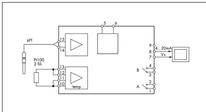
Fig.3 Trasmettitore passivo.
