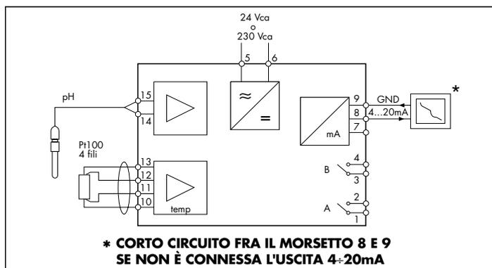
Fig.1 Trasmettitore attivo.
