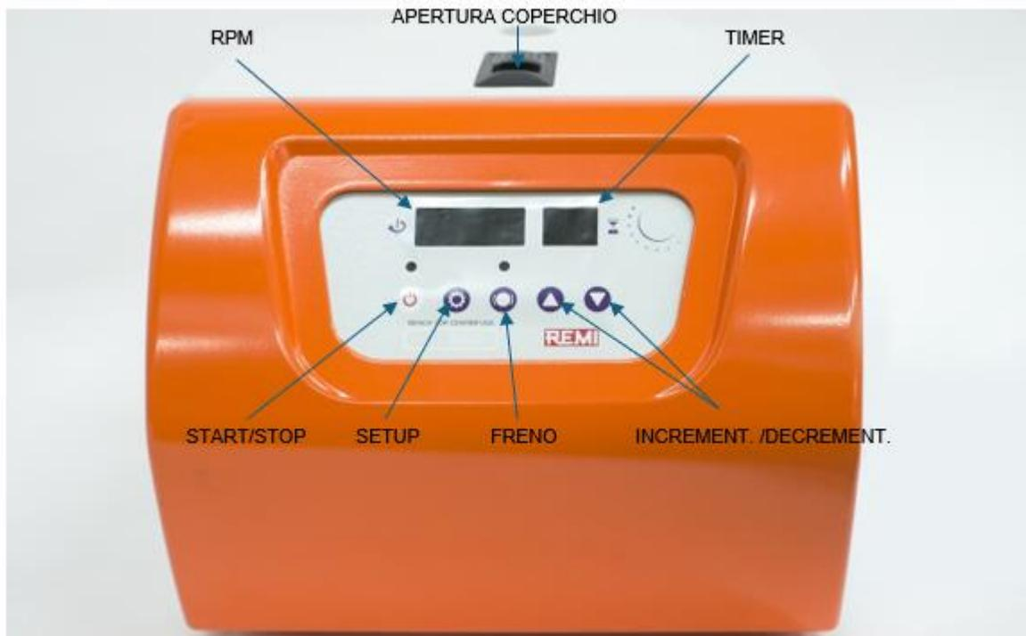
La figura sopra mostra il pannello frontale del display del R-5D. È composto da due display a 7 segmenti, 2 LED e 5 tasti.
